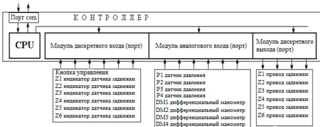
Рис. 2 – Структура системы управления насосной станцией низкого давления
