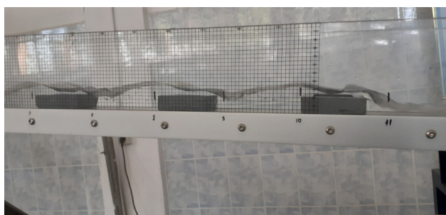
3 сурет – S8–MKLL қондырғысындағы су ағыны энергиясын бәсеңдеткіштің бойлық қималық көрінісі
