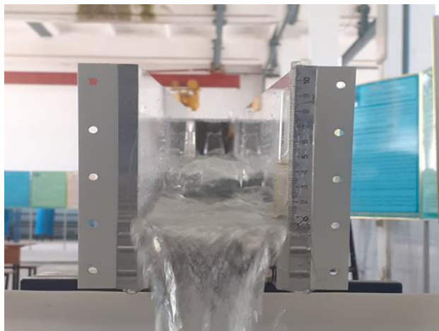
4 сурет – S8–MKLL қондырғысындағы су ағыны энергиясын төмендету процесінің көрінісі
