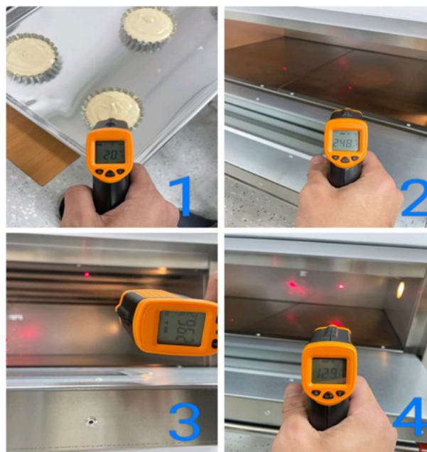
Сурет – VICTOR 304F пирометрімен бастапқы температураны өлшеу суреттері
