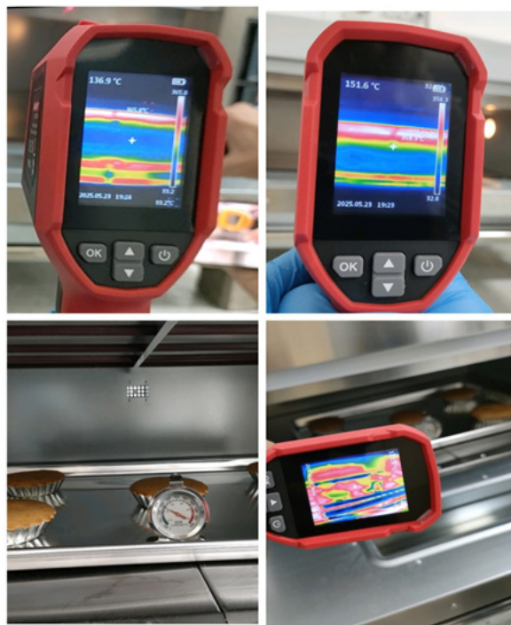
Сурет 4 – UTi120S тепловизорымен және MGprof термометрімен температураның таралуын зерттеу
