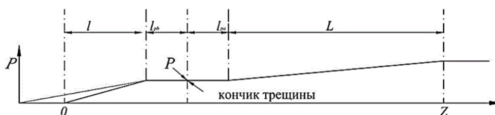
Рисунок 2 – Зависимость давления от продольной координаты трубопровода
