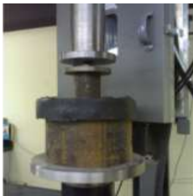
Рисунок 4 – Испытания крышки люка на механическую прочность на машине UTS
