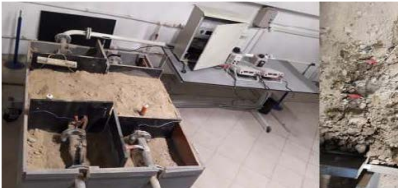
Рисунок 2 – Общий вид блока ЭХЗ модельной установки
