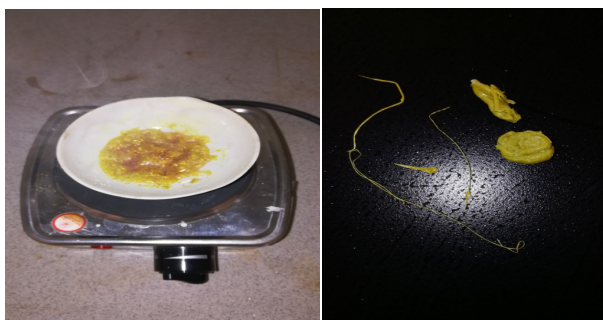
2 сурет – Пластикалық күкірт пен янтарь қышқылы тұзын араластырып балқыту процесі, түзілген өнім органикалық қышқылдардың жоғары молекулалы қосылысы
