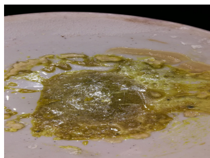
3 сурет – Түзілген өнім янтарь кристалы (кәріптас) Түзілген кристалл Фурье – ИК-спектроскопиялық әдіспен зерттелінді
