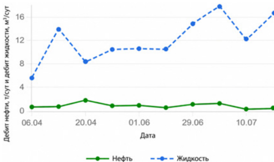
Рисунок 9 – ГРП по стандартной технологии, выполненный на тот же пласт, скв.216
