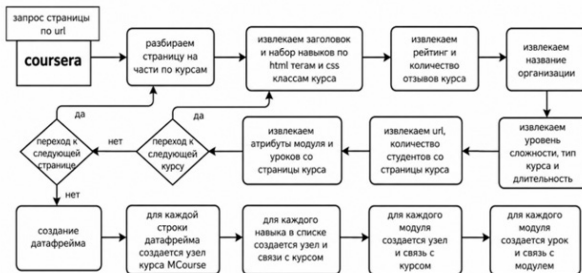
Рисунок 9 – Схема процесса создания узлов и связей графа знаний MOOK
