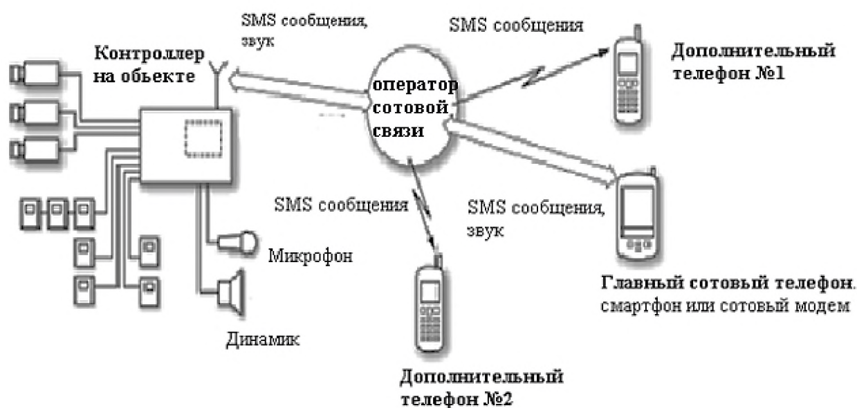
Рис. 1 – Передача сигнала тревоги с помощью SMS в GSM охранной системе
