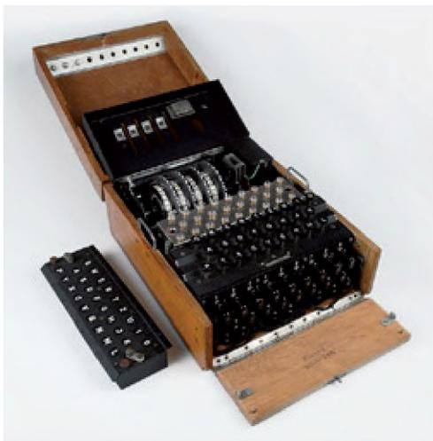
Рис. 1 – Шифровальная машина Третьего рейха «Энигма»
