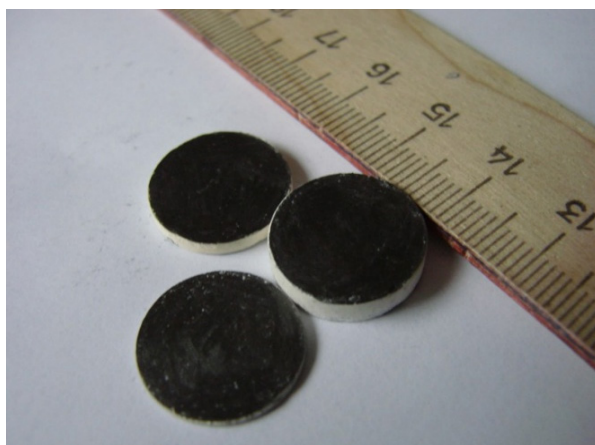
Рисунок 3 – Внешний вид наноионных конденсаторов на основе нанопорошков YSZ
