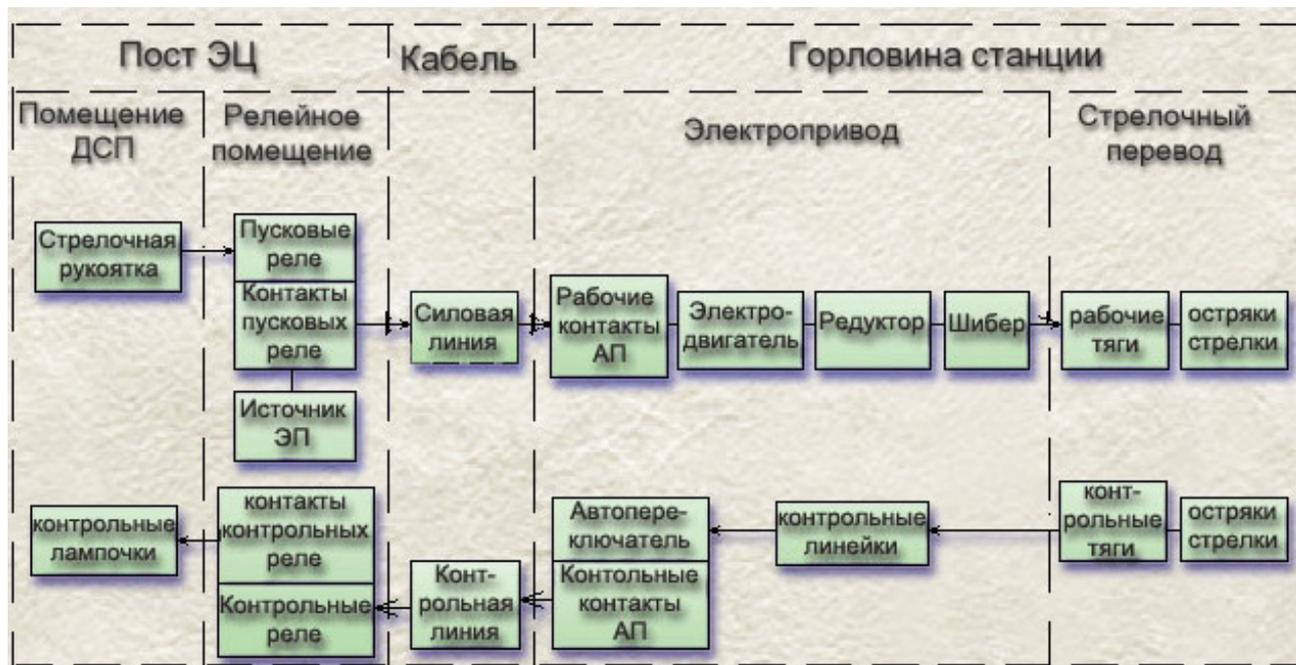
Рис. 1 – Общая блок-схема централизованной стрелки
