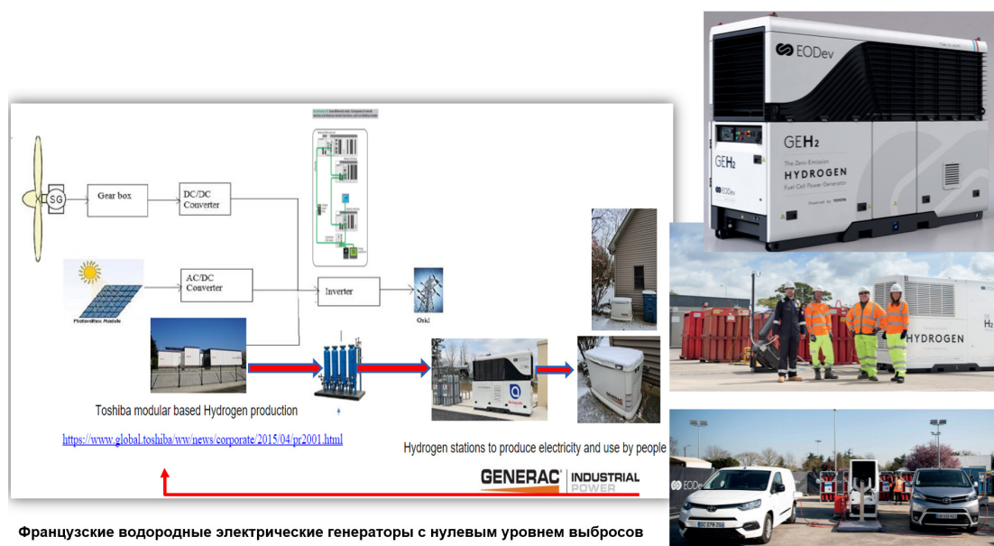
Рисунок 4 – Французские технологии водородных электрических генераторов GEN2 с нулевым уровнем выбросов [11, 12] с накопителями водорода в емкостях идентичных сжиженному природному газу, с последующим производством электроэнергии вполне могут заменить дорогие технологии хранения электроэнергии в батареях, практически могут заменить батареи
