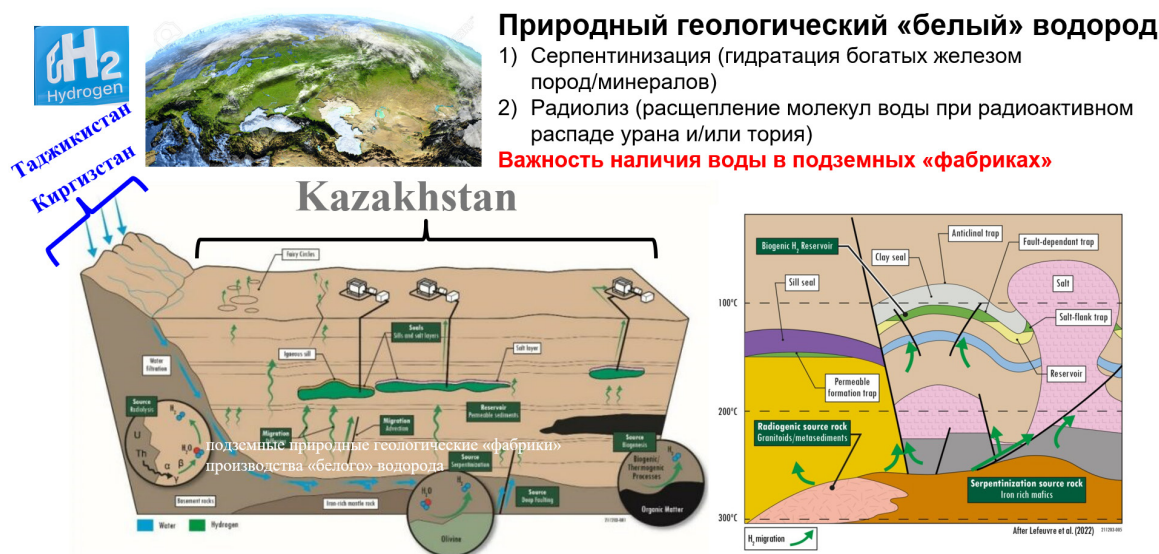
Рисунок 3 – Упрощенное изображение процесса выработки природного геологического «белого» водорода в подземных «фабриках», где требуется наличие подземных вод и среды для серпентинизации (гидратация богатых железом пород/минералов) и радиолизом (расщепление молекул воды при радиоактивном распаде урана и/или тория), источник [10]
