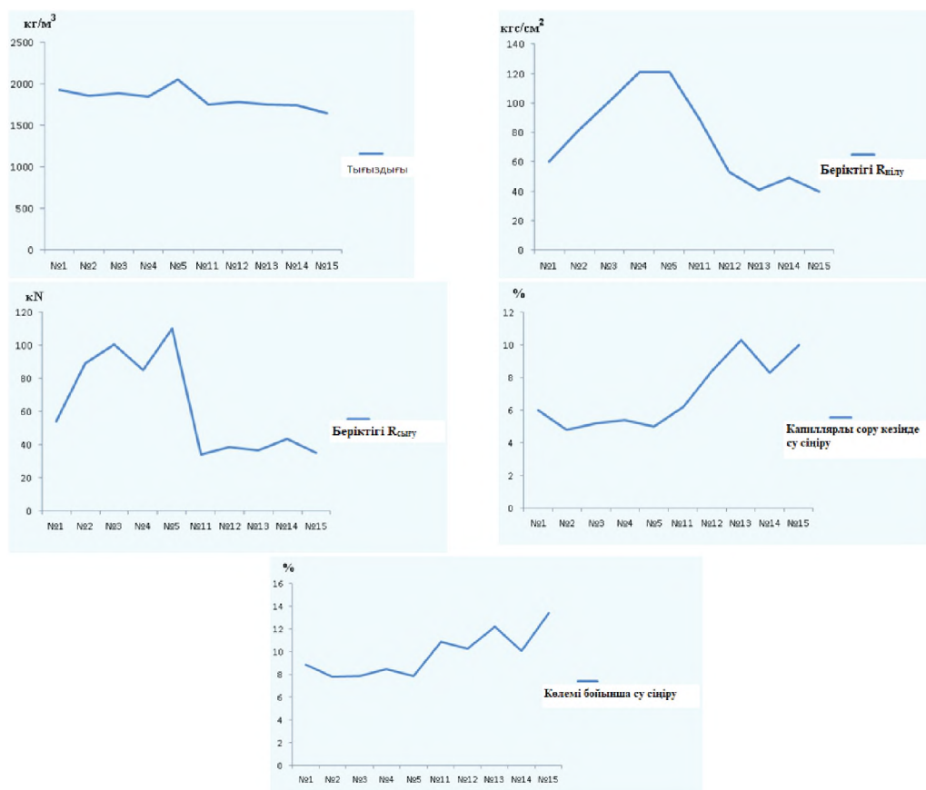
2-сурет. Ақ күйені қолданумен құрғақ құрылыс қоспаларының физика-механикалық қасиеттері
