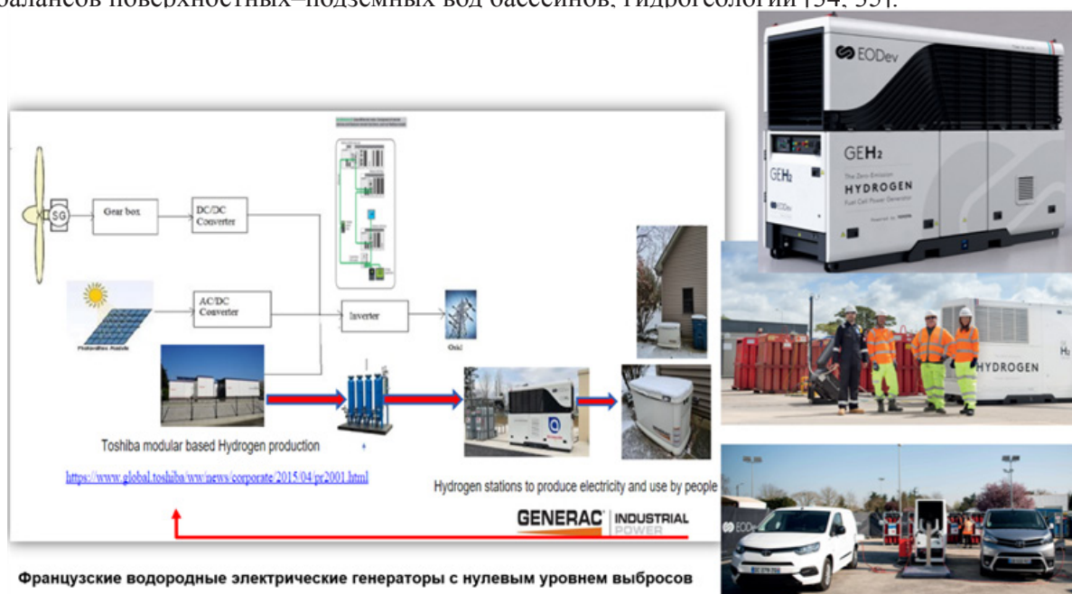
Рисунок 11 – Французские технологии водородных электрических генераторов GEN2 с нулевым уровнем выбросов [33, 34, 35] с накопителями водорода в емкостях, идентичных сжиженному природному газу, с последующим производством электроэнергии вполне могут заменить дорогие технологии хранения электроэнергии в батареях, практически могут заменить батареи
