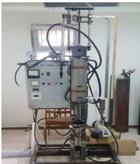
Сурет 1 – Газ фазасындағы доғалық разряд әдісі қондырғысының құрылымы
