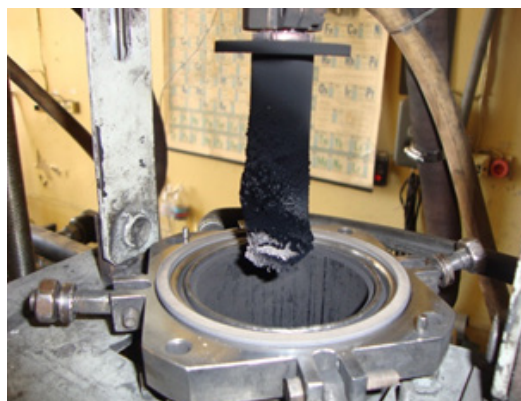
Сурет 2 – Синтезделген фуллерен күйесі (а) мен катод материалына жиналған фуллерен күйесінің (б) суреті
