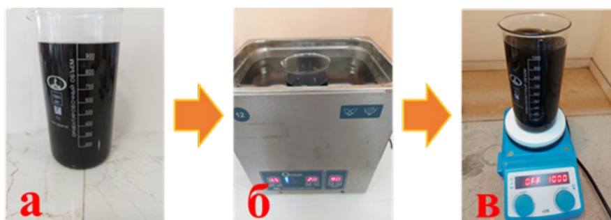
Сурет 2 – Графен оксидін (ГО) бейтараптау реті: а) деионсызданған су құю; б) ультрадыбыстық ваннаға салу; в) магниттік араластырғышқа қою;
