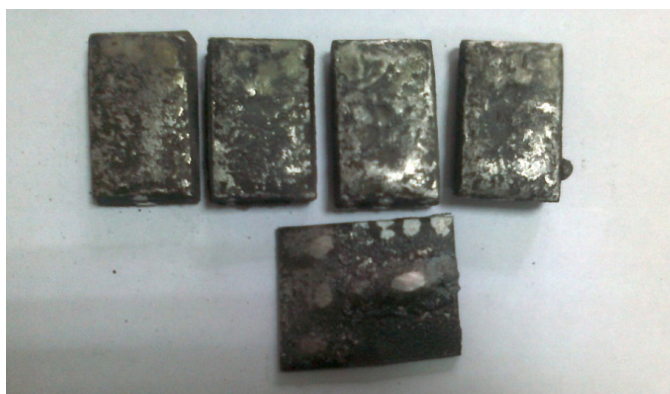
Рис.3 – Образцы с отчищенной поверхностью от следов коррозии
