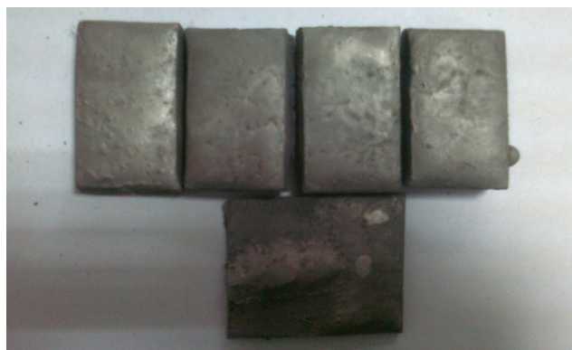
Рис.1 – Образцы с нанесенным покрытием до проведения коррозионных испытаний
