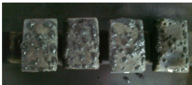
Рис.2 – Образцы с нанесенным покрытием после проведения коррозионных испытаний
