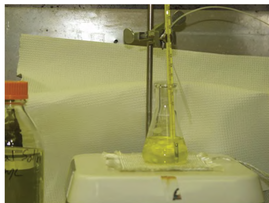
1-сурет. Тұз қышқылымен шаймалау арқылы фосфорит шикізатынан висмут-құрамдас қоспаны бөліп алу
